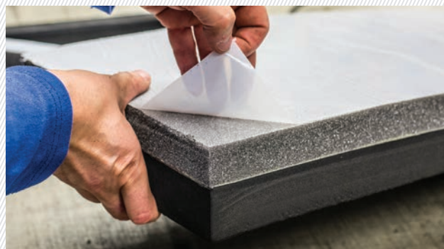
4. Ukážka samolepiacej vrstvy na hotovom sendviči
