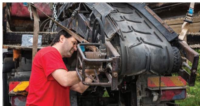
• Demontáž poškodeného gumového profilovaného pásu.
