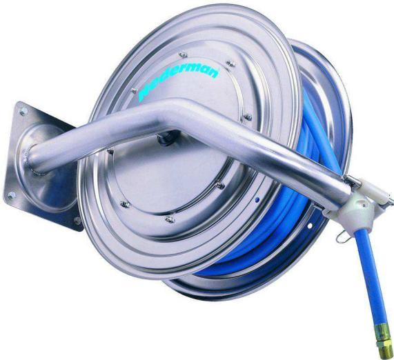
Tento hadicový naviják je kompletně vyroben z nerezové oceli a je určen speciálně pro potravinářský průmysl. Díky zaobleným rohům a hranám se snadno čistí. Rameno pro odvíjení hadice a externí otočná konzola se snadno rozebírají. Naviják obsahuje jen minimum spojů.
